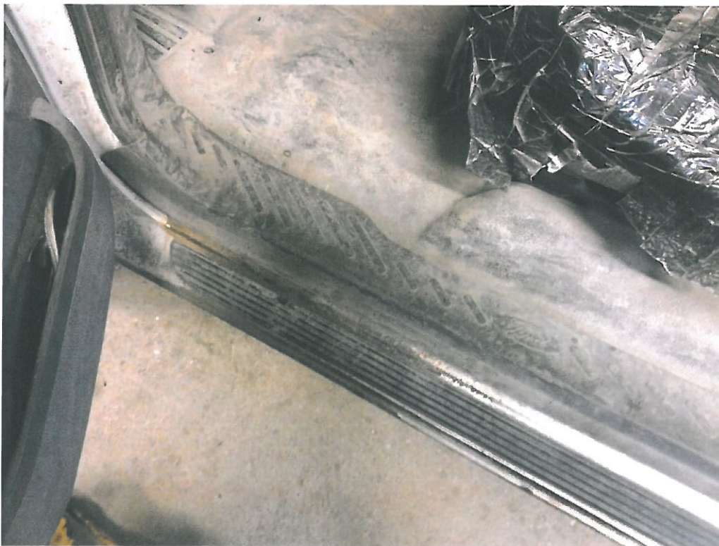
Door sill rusting
