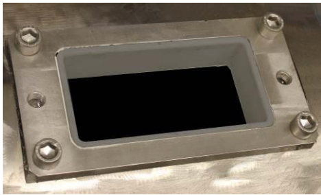
Tungsten carbide cake discharge ports
